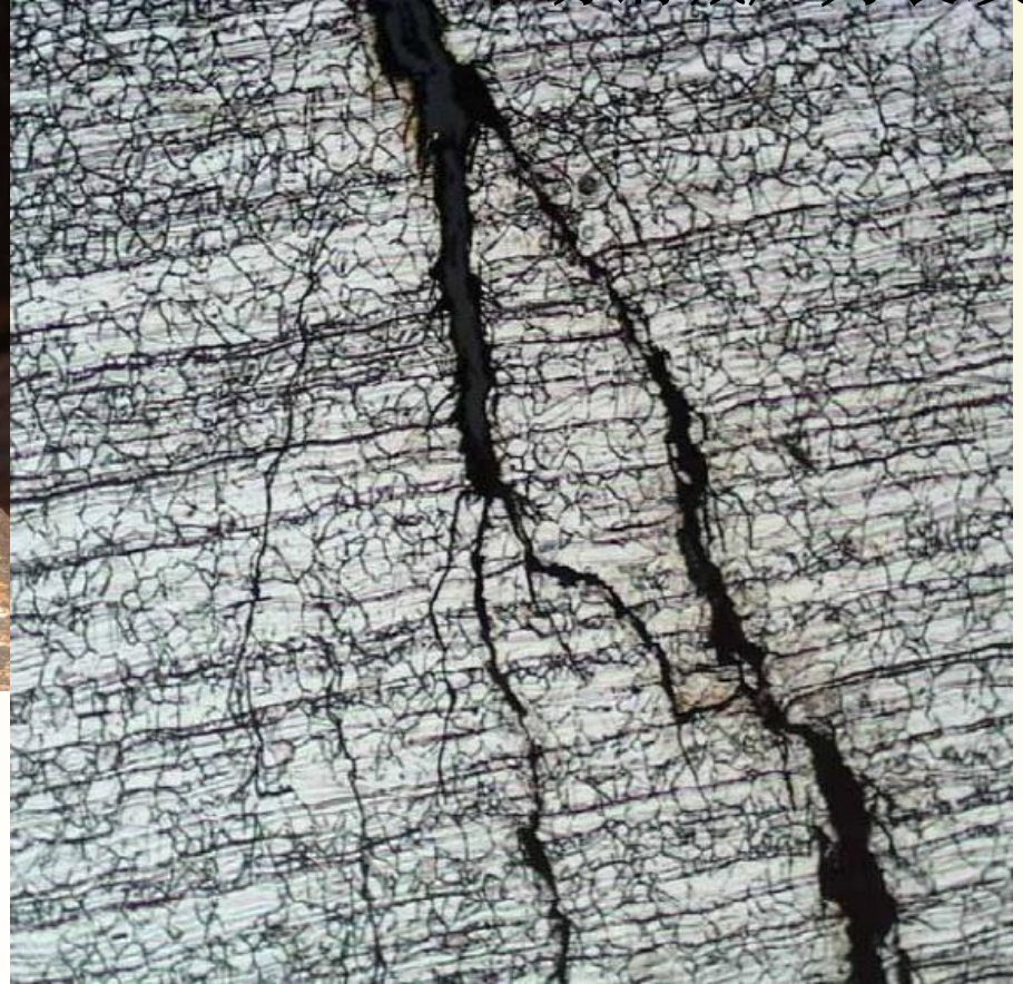
321不锈钢碱应力裂纹
