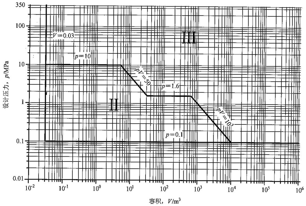
图 A-1 压力容器分类图——第一组介质
