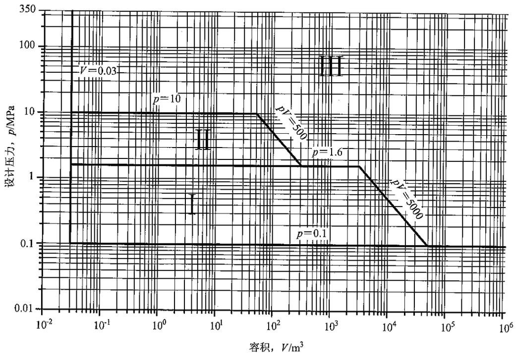
图 A-2 压力容器分类图——第二组介质
